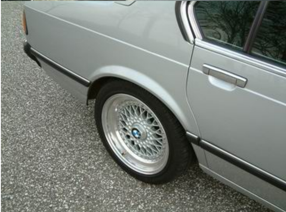
De achteras is 40mm langer en de vooras is 60mm korter. De auto heeft 40mm verlengde veren en BBS RS1 velgen 3
