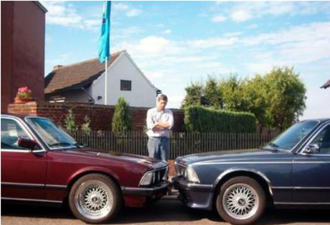
Rot: H&P Sportfahrwerk Blau: werkmäßig sportlich angepasste Fahrwerk
